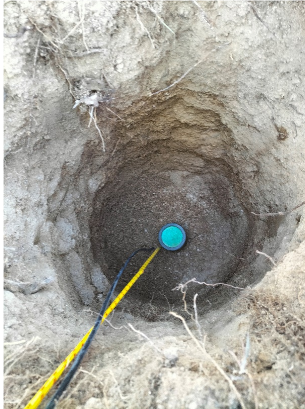
Figura 3: Posición del electrodo dentro del hueco.
